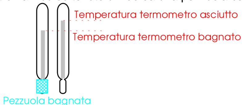
Dalla differenza delle temperature misurate dai due termometri, e da una delle due temperature, si ottiene, entrando in tabelle appositamente costruite, sia l' umidità relativa che il punto di rugiada.
